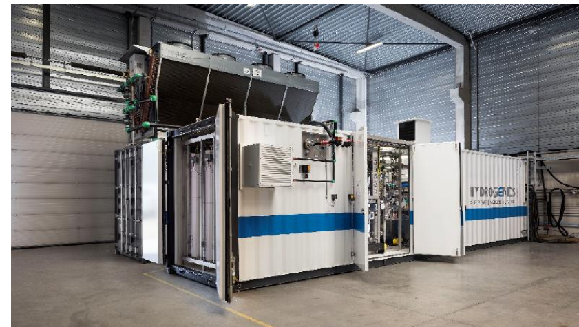
Przykładowy elektrolizer HyLYZER 500-30 bar
