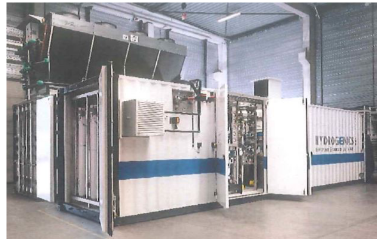
Przykładowy elektrolizer HyLYZER 1000-30 bar
