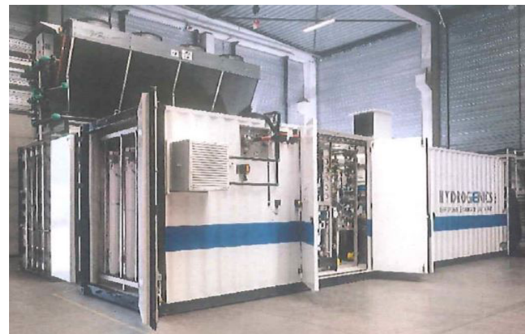
Przykładowy elektrolizer HyLYZER 1000-30 bar
